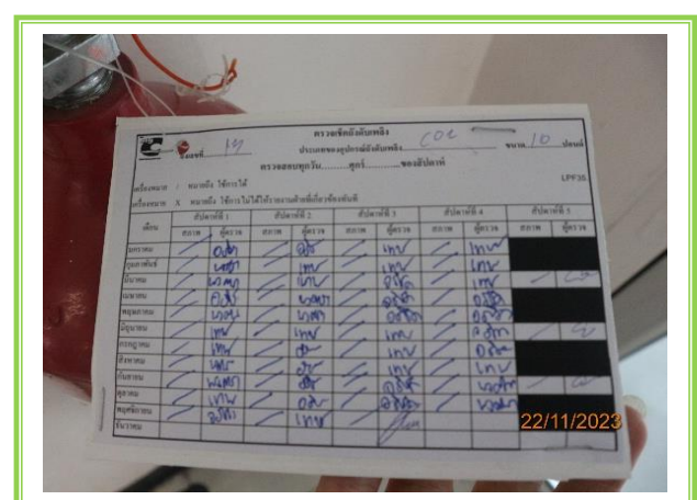
รูปที่ 3-51 การตรวจสอบถังดับเพลิง
