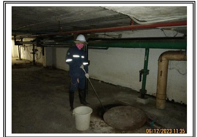
รูปที่ 4.4-18 แสดงการเก็บตัวอย่างน้ำทิ้ง บริเวณบ่อปรับอัตราการไหล (บ่อ EQ) เก็บตัวอย่างในวันที่ 6 ธันวาคม 2566
